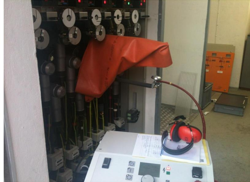
Bei der Kabelprüfung (Stehspannungsprüfung) wird zwischen der Mantelprüfung und der eigentlichen Kabelprüfung unterschieden.
