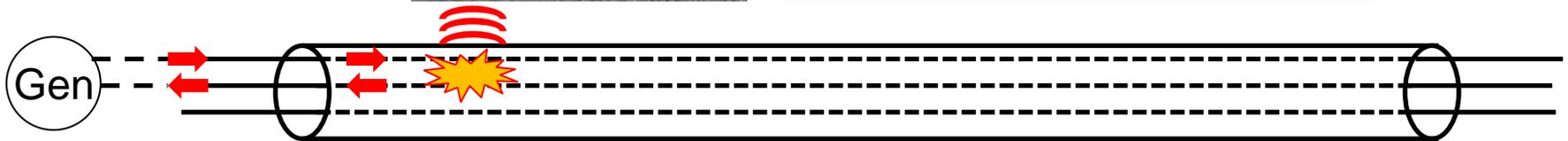
Der Stossgenerator wird aktiviert und es erfolgen 20 Entladungen / Min. Die kleinste Zeitdifferenz (in ms) zwischen dem magnetischen Impuls (Blitz,  $3 \times 10^8 \text{ m/s}$ ) und dem Knall (Donner,  $330 \text{ m/s}$ ) bestimmt den Fehlerort.
